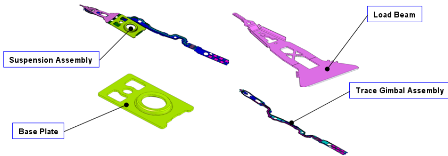
รูปที่ 3 ชิ้นส่วนประกอบของชุดจับยึดหัวอ่าน/เขียน
