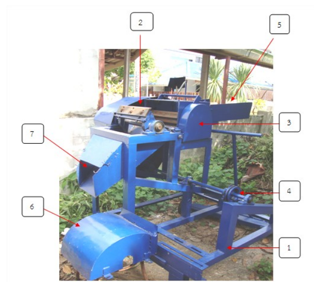
ภาพที่ 1 ส่วนประกอบของเครื่องสับยอดอ้อยและต้นข้าวโพด
