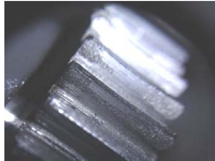
รูปที่ 6 การสึกหรอแบบตามดทางไฟฟ้าระยะรุนแรงของฟันเฟืองทดสอบ
