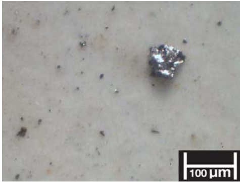
รูปที่ 11 อนุภาคการสึกหรอที่ได้จากสารหล่อลื่นในช่วงการสึกหรอรุนแรง (แสดงอนุภาคทรงกลมและอนุภาคแบบลำตัว)
