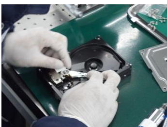
รูปที่ 4 การประกอบ Actuator Arm
