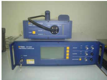
รูปที่ 2 แสดงภาพเครื่องวัด LDV
