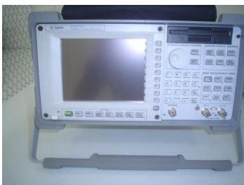
รูปที่ 3 แสดงภาพเครื่อง DSA
