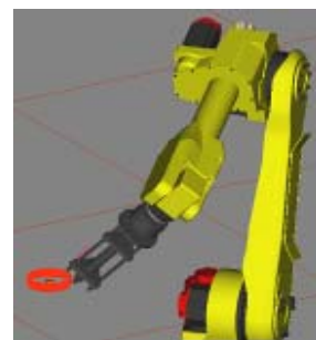
รูปที่ 8 การจำลองเส้นทางเดินปลายแขนกลในโปรแกรมคอมพิวเตอร์เพื่อวิเคราะห์การเคลื่อนที่ของข้อต่อแขนกล
