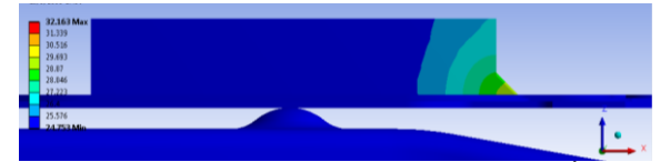
รูปที่ 8 แสดงการกระจายตัวของอุณหภูมิที่เกิดขึ้นบนชิ้นส่วนต่างๆ HGA ณ เวลาที่ 0.002 วินาที
