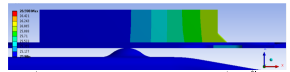
รูปที่ 9 แสดงการกระจายตัวของอุณหภูมิที่เกิดขึ้นบนชิ้นส่วนต่างๆ HGA ณ เวลาที่ 0.006 วินาที
