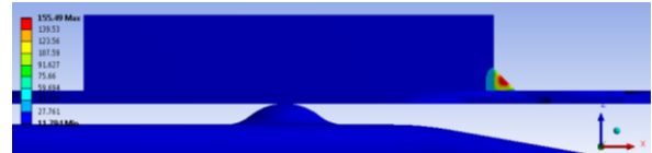
รูปที่ 7 แสดงการกระจายตัวของอุณหภูมิที่เกิดขึ้นบนชิ้นส่วนต่างๆ HGA ณ เวลาที่ 0.0011 วินาที
