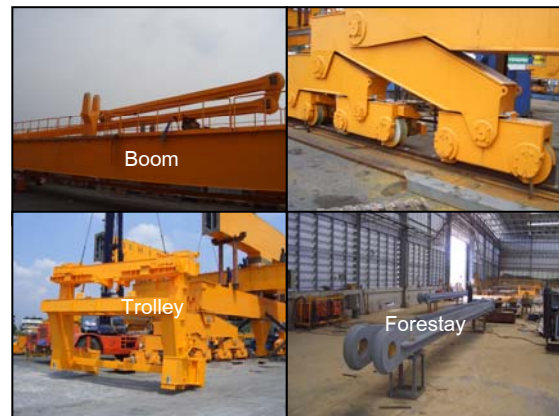
รูปที่ 5 แสดงภาพถ่ายโครงสร้างเครน
