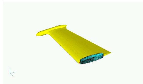
รูปที่12 การใส่จุดจับยึดที่ปีกแบบยึดทั้งชิ้นส่วน
