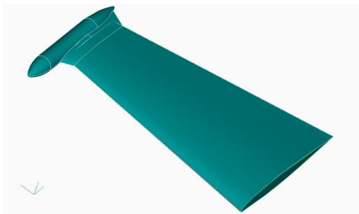
รูปที่ 3 แบบจำลอง 3 มิติ ของปีก บ.ขฝ.1
