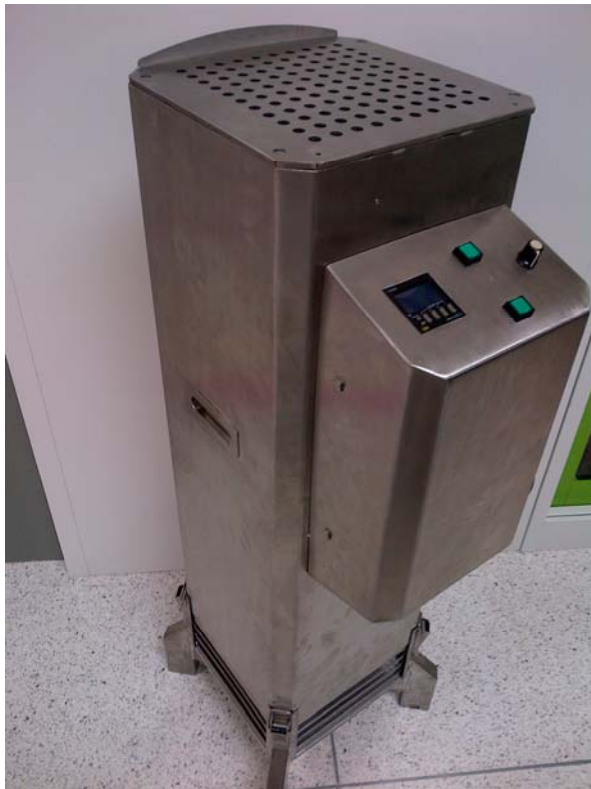
รูปที่ 2 รูปถ่ายต้นแบบเครื่องบำบัดอากาศภายในอาคารที่พัฒนาขึ้น
