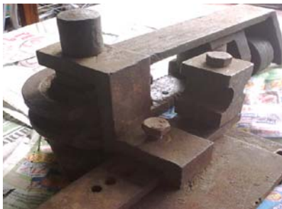
(ค) เครื่องตัดท่อแบบที่ 3
