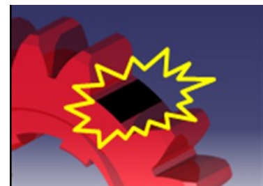
รูปที่ 3 สภาวะความเสียหายเงื่อนไขที่ 2 จำลองความเสียหายที่ฟันเฟืองตัวตามแตกหัก 100%
