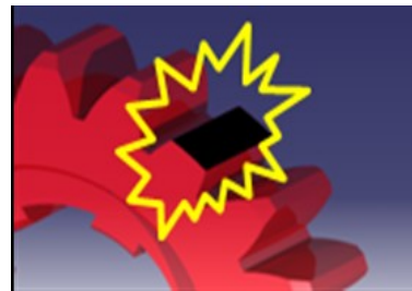
รูปที่ 2 สภาวะความเสียหายเงื่อนไขที่ 2 จำลองความเสียหายที่ฟันเฟืองตัวตามแตกหัก 50%
