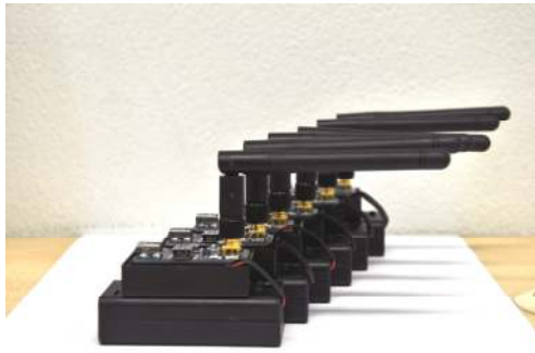
รูป 6 อุปกรณ์รับและส่งสัญญาณด้วยคลื่นวิทยุจาก Sensor
