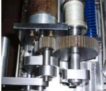
รูปที่ 9 ระบบส่งกำลัง
