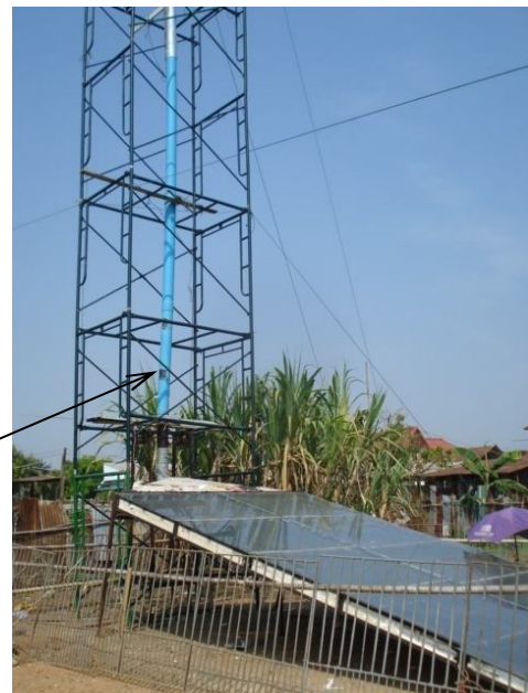
รูปที่ 7 ต้นแบบของโรงไฟฟ้าปล่องลมแสงอาทิตย์
