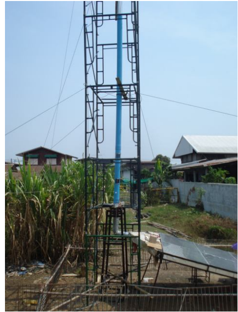
รูปที่ 6 ต้นแบบของโรงไฟฟ้าปล่องลมแสงอาทิตย์
