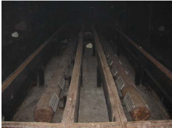
รูปที่ 4 ท่อกระจายลมร้อนในห้องรมคว้น ขนาดห้องกว้าง 4.12 เมตรยาว 12 เมตรสูง 4.7 เมตร
