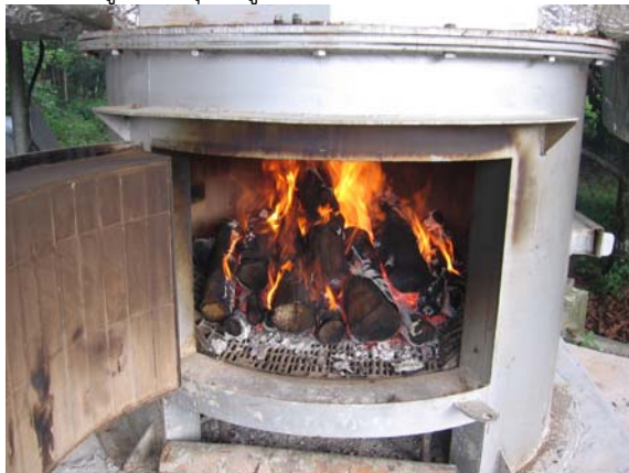
รูปที่ 8 การป้อนเชื้อเพลิงในเตากำเนิดความร้อน
