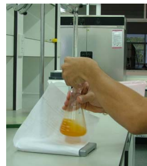
รูปที่ 21 แสดงการทำไทเทรตด้วย NaOH 0.0995 N
