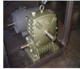
รูปที่ 6 ชุดระบบการส่งกำลังของเครื่องจักร
