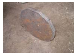
รูปที่ 8 ฐานมีดที่ผ่านการตัดด้วยเครื่องตัดแก๊สอัตโนมัติ
