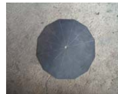
รูปที่ 7 การวาดแบบลงเหล็กแผ่นขนาดบางเพื่อทำแบบ
