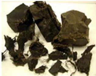
รูปที่ 3 เศษชิ้นส่วนยางที่ผ่านการย่อยโดยเครื่องย่อยติดใบมีด [1]
