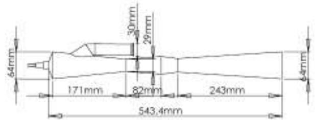
Fig. 2 Dimension of Valve-less pulsejet
