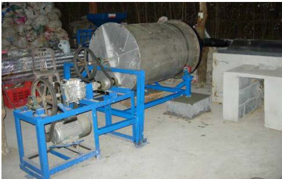
รูปที่ 4 เครื่องอบแบบถึงหมุนที่สร้างขึ้น
