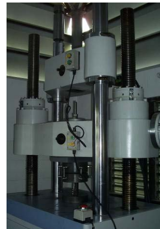
รูปที่ 4 แสดงเครื่องทดสอบ Compressive Testing Machine
