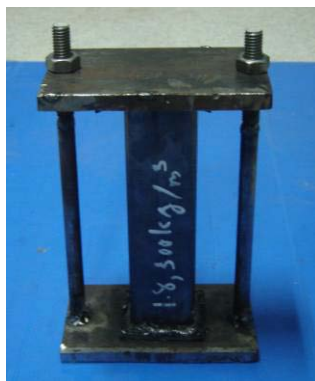
รูปที่ 3 แสดงอุปกรณ์ควบคุมความหนาแน่นของโฟมขณะใช้งาน
