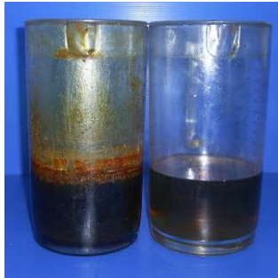
รูปที่ 1 แสดงของเหลว 2 ชนิด โพลีออลและไดไอโซไซยาเนต ซึ่งผสมกันแล้วจะได้เป็นโพลียูรีเทนโฟม
