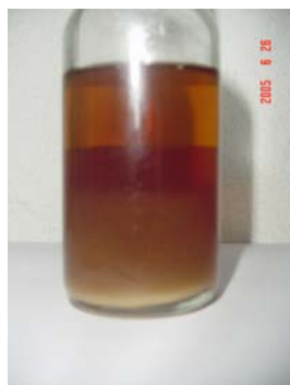
รูปที่ 6. ลักษณะการแยกชั้นระหว่างเอสเทอร์และกลีเซอรอล
