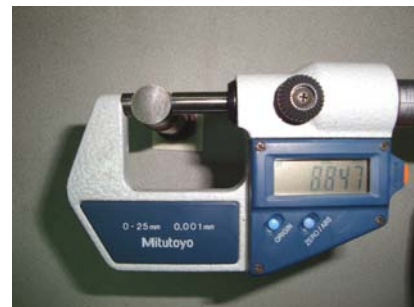
ข. ขนาดเส้นผ่านศูนย์กลางของพันธหลังเคลือบผิว TiCN-CVD คือ 8.847 มม.
