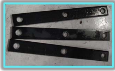
รูปที่ 2 ชิ้นงานที่ผ่านการตัดเจาะจากแม่พิมพ์
