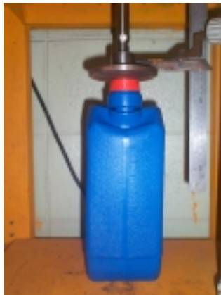
รูปที่ 1 กระป๋องทดสอบขนาด 5.0 ลิตร ในขณะทำการทดสอบการดำนบน แสดงการยุบตัวเกิดขึ้นที่คอขวด
