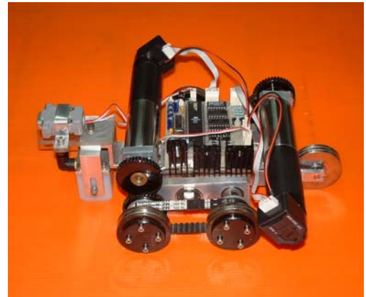
รูปที่ 8 ลักษณะและรายละเอียดชิ้นส่วนของหุ่นยนต์ตรวจสอบความหนาของถังบรรจุน้ำมันปิโตรเลียมโดยใช้อัลตราโซนิค
