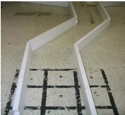
รูปที่ 8 ภาพแสดงช่องทางเดินตามฝาผนังที่ใช้ในการทดลอง ซึ่งมีขนาดกว้างของช่องทางเดินกว้าง 0.5 เมตร สูง 0.2 เมตร และ ยาว 3 เมตร
