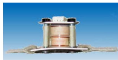
รูปที่ 1 ตัวกระตุ้นสั่นสัมผัสโซลินอยด์ที่ใช้ในการทดลอง
