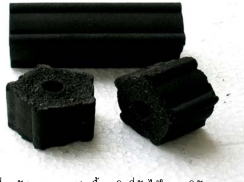
รูปที่ 3 ลักษณะของแท่งเชื้อเพลิงที่อัดได้ในงานวิจัย
