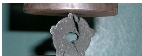
รูปที่ 3 ลักษณะของแท่งเชื้อเพลิงที่อัดได้ในงานวิจัย
