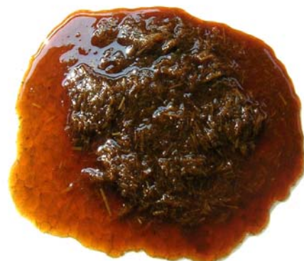
รูปที่ 1 แสดงลักษณะของตัวประสานฟางข้าวหมัก
