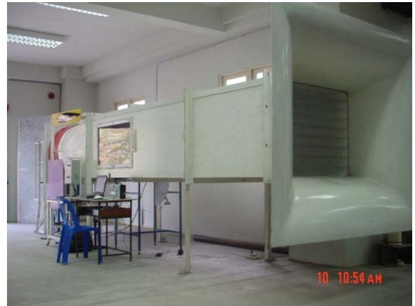
รูปที่ 3 การทดสอบโรเตอร์ในอุโมงค์ลม
