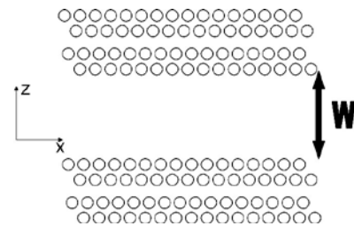
รูปที่ 1 ภาพแสดงลักษณะของท่อหรือช่องการไหลแบบราบเรียบ
