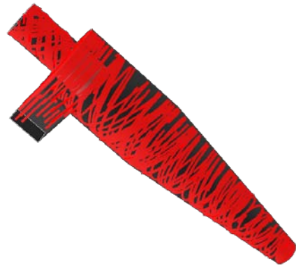
รูปที่ 3 โปรไฟล์ความเร็วหมุนวนภายในไซโคลน
