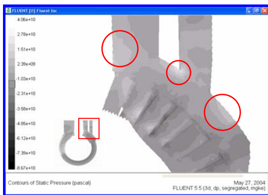
รูปที่ 7 การเกิดจุดหยุดนิ่งที่ทางออกของบิมน้ำ
