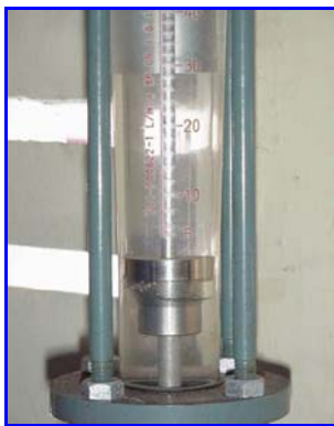
รูปที่ 25 การวัดอัตราการไหลในการทดลองเพื่อหาค่าประสิทธิภาพของ ปั้มน้ำ
