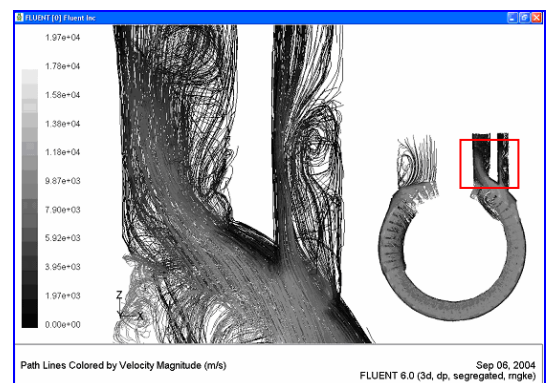
รูปที่ 10 การเกิดการไหลวนที่ช่องนำไหลออก
