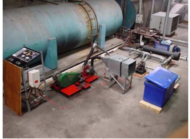
รูปที่ 10 ต้นแบบเครื่องทำความเย็นที่ใช้อากาศเป็นสารทำความเย็น
