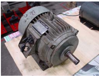
รูปที่ 16 มอเตอร์ขับเคลื่อนเครื่องอัดอากาศ
