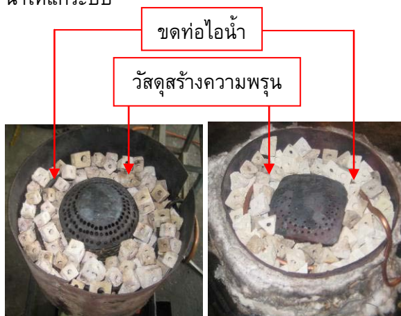
รูปที่ 3 ลักษณะของหัวเผาน้ำมันปาล์มหลังการปรับปรุง
