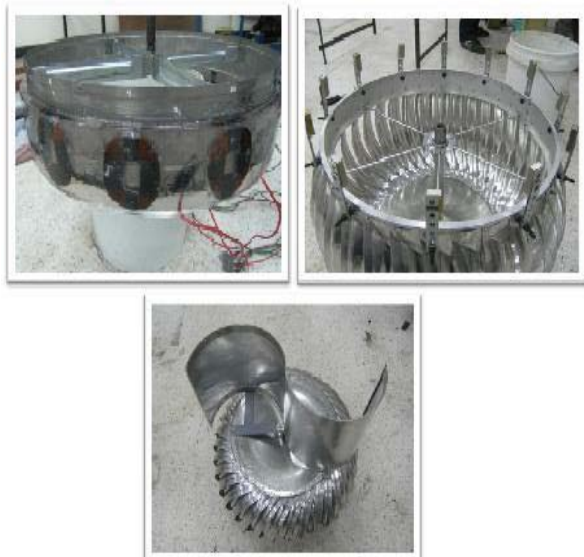
รูปที่ 3 การติดตั้งชุดผลิตไฟฟ้าและใบรับลม ในการออกแบบแรงดันไฟฟ้าจากลูกหมุนเพื่อนำไปเลือกขนาดของแบตเตอรี่อาศัยสมการดังนี้ [5]
