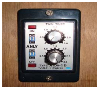
รูปที่ 5 ชุดสวิตช์ควบคุมและตัวหน่วงเวลา
