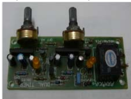
รูปที่ 2 ชุดควบคุมการทำงานคือ Timer Duo เป็นตัวควบคุมแบบอัตโนมัติ
