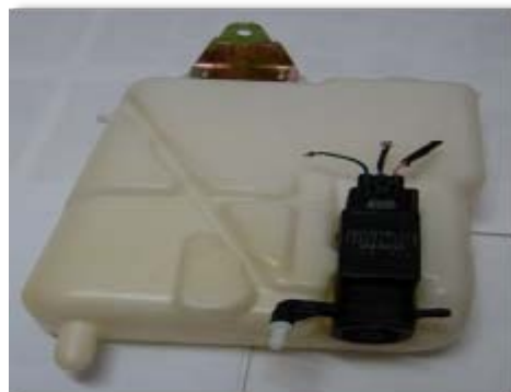
รูปที่ 1 ชุดปั๊มน้ำและถังน้ำของชุดฉีดกระจกรถยนต์
