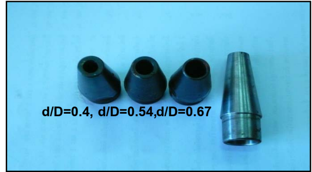
รูปที่ 4 แสดงอัตราส่วนพื้นที่หน้าตัดของหัวฉีดกับห้องผสม
