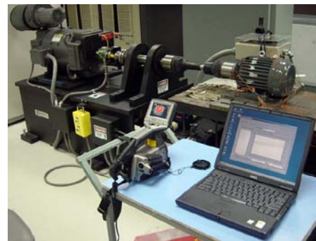
รูปที่ 2 การทดสอบประสิทธิภาพของมอเตอร์ไฟฟ้า และการวัดอุณหภูมิ
