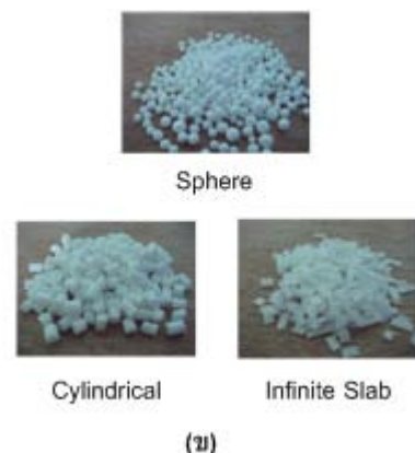
รูปที่ 1 (ก) แสดงขนาดของวัสดุทดสอบ 3 ชนิด (ข) ลักษณะของวัสดุทดสอบ 3 ชนิด
