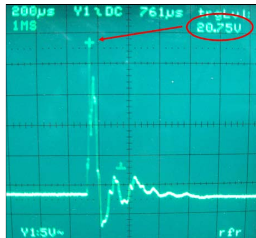
รูปที่ 8 แรงเคลื่อนไฟฟ้าจาก PVDF फिल्म เมื่อถูก กระแทกด้วยความดันจากลำพุ่งของน้ำ
