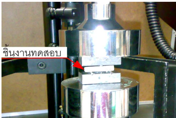
รูปที่ 7 การทดสอบความเค้นดัดของวัสดุเชิงประกอบที่อัตราส่วน Py:So:Po ที่ 37.5:37.5:25
