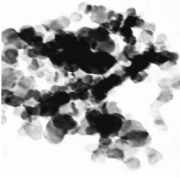
รูปที่ 1 แสดง TEM micrograph TiO 2 (21 nm) [8]
