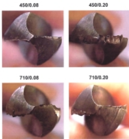
รูปที่ 7 ลักษณะการสึกหรอของปลายดอกสว่าน ในการทดลองวัดสัญญาณอะคูสติก
