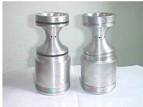
รูปที่ 3 แสดงคอขวดของ mixing device ในเครื่องยนต์ก๊าซชีวภาพ [6]
