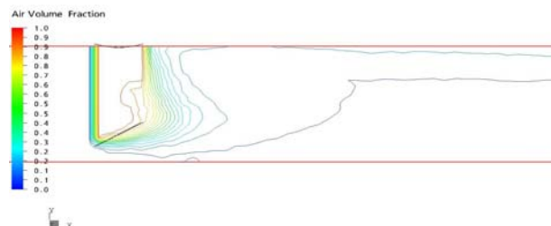
รูปที่ 9 แสดง contour line ของ volume fraction ของ อากาศที่ H = 0.75D , \theta = 30 , และ Qa/Qw = 0.4
