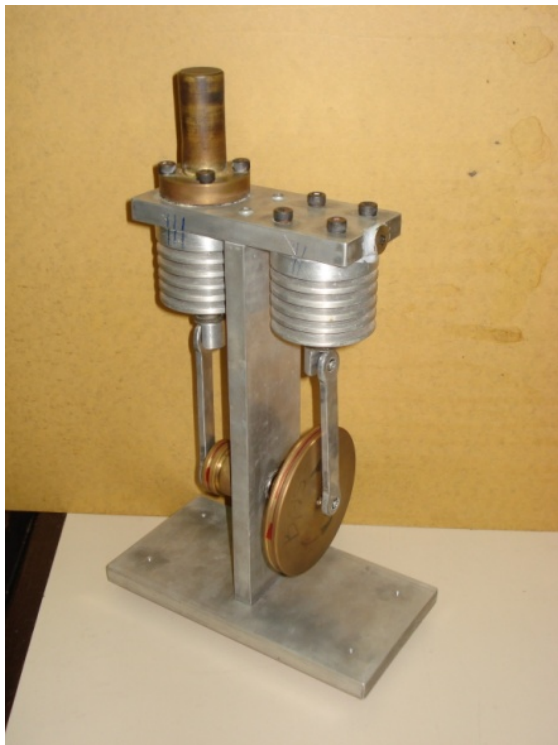
รูปที่ 2 เครื่องยนต์สเตอร์ลิงชนิดอัลฟ่าที่สร้างเสร็จแล้ว
