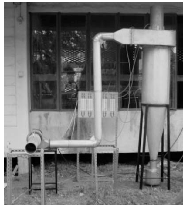
รูปที่ 1 ภาพแสดงชุดทดลองไซโคลนชนิด Forced Vortex
