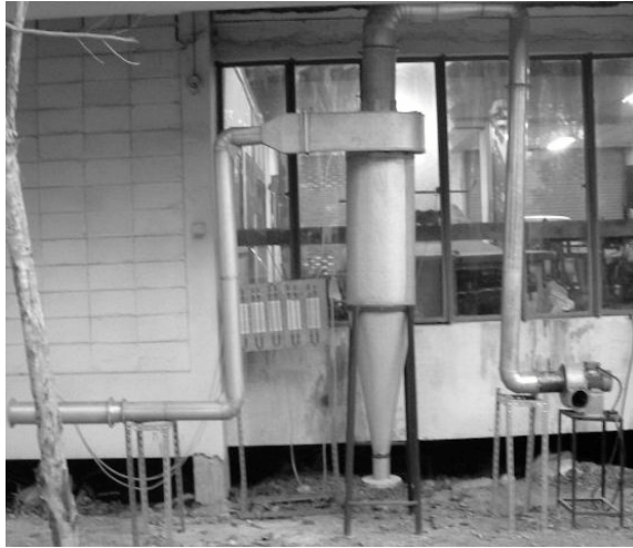
รูปที่ 2 ภาพแสดงชุดทดลองไซโคลนชนิด Free Vortex
