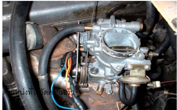
รูปที่ 6 แสดงการติดตั้งอุปกรณ์วัดตำแหน่งปีกผีเสื้อ
