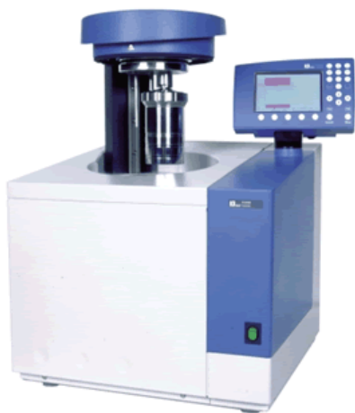
รูปที่ 2 เครื่องทดสอบหาค่าทางความร้อน (IKA รุ่น C2000)
