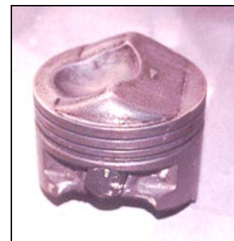
ข.) ลูกสูบแบบหัวนูนสามเหลี่ยม รูปที่ 3 ลูกสูบที่ใช้ในการทดลอง
